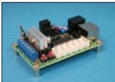
写真4 ロボット制御基板
