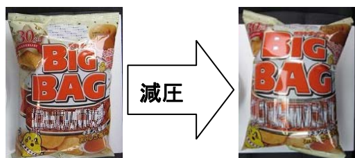
伊勢原市街 (高度約 40m) 富士山新五合目 (高度 約 2350m) 第5図 山で膨らむお菓子の袋
