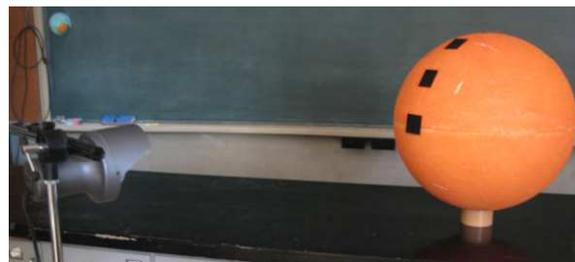
第6図 直径50cmの発泡スチロール球による受光角度と上昇温度の関係調べる実験の様子
