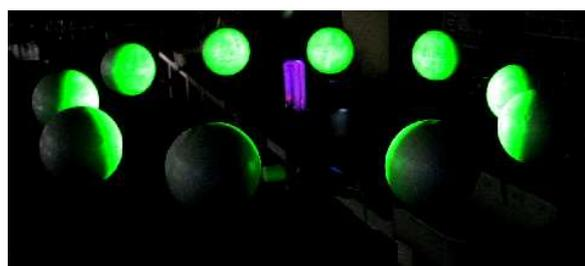
第4図 演示用金星の満ち欠けモデル実験器
