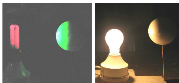
第3図 ブラックライトと蛍光塗料を塗布したもの(左)と白熱球と蛍光塗料未塗装(右)のもの比較
