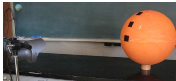
第6図 直径50cmの発泡スチロール球による受光角度と上昇温度の関係調べる実験の様子
